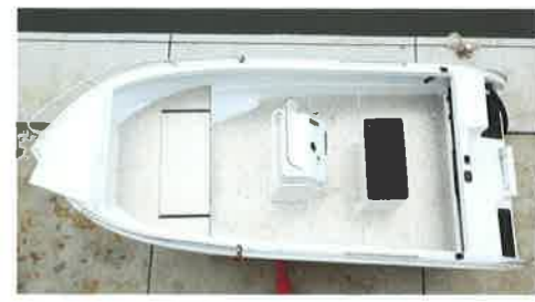
まだ織装前の状態の日本仕様プロダクションモデルです。もともとカーペット張りだった船内床は、ノンスリップパターン付きのアルミ板となり、清掃が容易になっています
