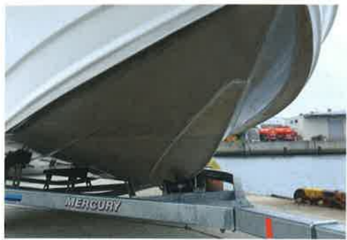
絞り込みがきつくなるフォアフット部分のみ、別に成型したパーツを溶接。このモデルでは、それを利用してこの部分の板厚を増しており、船首部の補強も行っています
