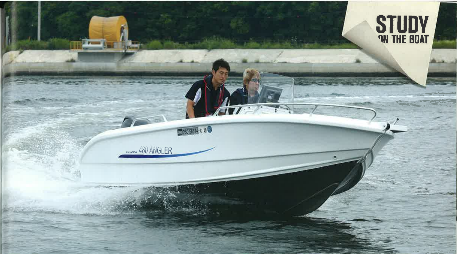
中速旋回。このサイズのモデルとしては、安定感のある旋回です。試乗艇が装備していたトルク重視型プロペラの性格なのかもしれません
