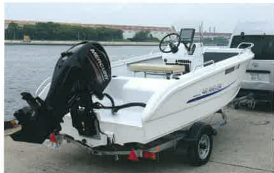
トレーラーパッケージで付属するトレーラーに載せた状態。トレーラーとエンジン付きの艇体を合わせても、牽引免許不要範囲の750キロには、まだかなりの余裕があるようです
