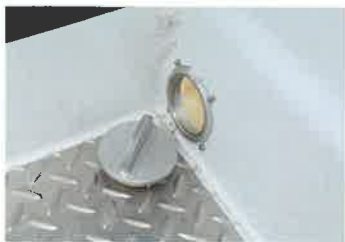
船尾側の両舷、ほぼ床レベルに設けられた排水用のスカッパー。日本仕様のために設けられたもので、エサ釣りのあとの清掃や、雨水の排水などに利用できます
