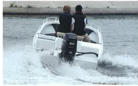
コンケイブV系のハルは、旋回で内傾した際に内側の船底で発生する揚力が増しやすい形状です。そのため、このモデルでも、旋回時の内傾は少なめでした
