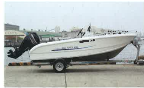
まだ織装前の状態の日本仕様プロダクションモデルです。もともとカーペット張りだった船内床は、ノンスリップパターン付きのアルミ板となり、清掃が容易になっています
