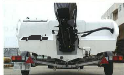
小型のアルミボートとしては、深いフォアフットを備えたモデルで、ミジップから船首にかけては、かなりねじれのある船型ですが、主な滑走面がコンケイブであるためか、旋回時にそれほど大きく内傾せず、そのため、あまり船首が明確に下がるといこともありませんでした。船尾側から見ると、このモデルの船底がコンケイブ系のV型であることがよくわかります。ストレーキとストレーキの間は直線ではなく、円弧でつながっています。チェーン部分のリップには、下反角が備わっており、揚力発生とローリング抑制に役立っているものと思われる
