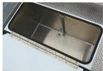
ヘルムシートの内部はライブウェル。直立したパイプは、水を噴出するタイプのエアレーターです。寸法から計算すると、エアレーターが使える範囲でも容量は100リットルほど
