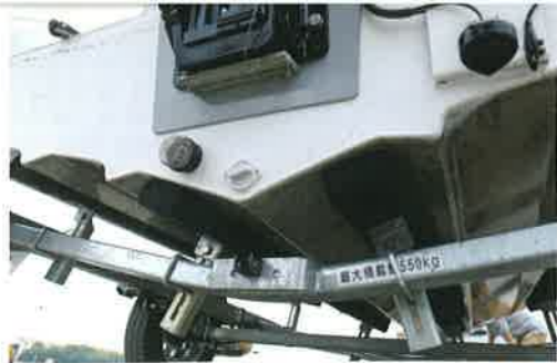
船底は片舷2条のストレーキを含めて、プレス加工された一体成型物となっています。どのくらいのサイズまで同じ手法が可能なかわかりませんが、かなり合理的な構造です
